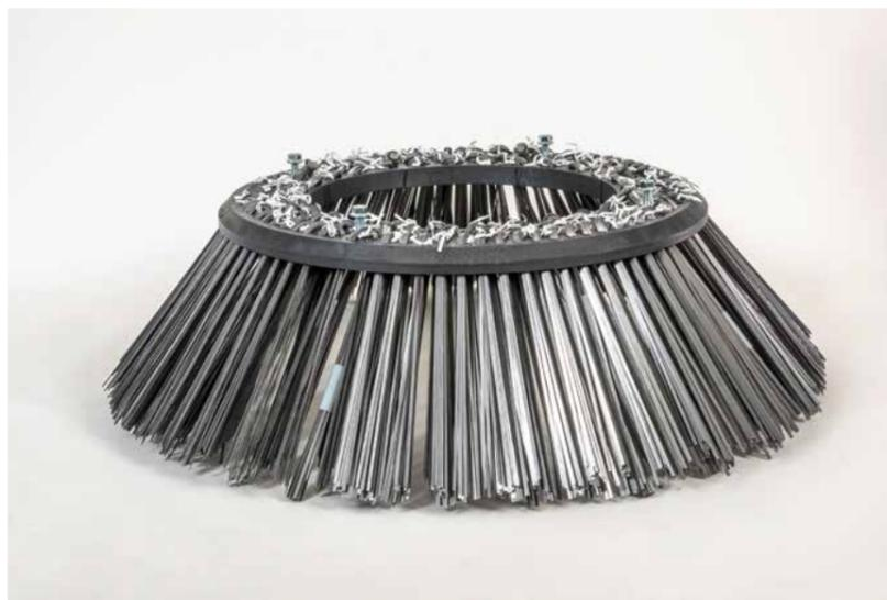
Dieser Unkrautbesen wird im Vergleich zur gewöhnlichen Insieme-Ausführung noch mit 4-8 Flachstahlbüscheln verstärkt. Dieser Besen wirkt etwas aggressiver und wird vorzugsweise zur Unkrautbeseitigung entlang der Wassersteine eingesetzt.
