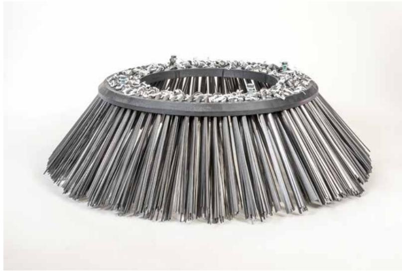
Dieser Unkrautbesen zeichnet sich durch seine Einfachheit aus. Die Flachstahlbüschel werden entgegen der Kehrrichtung angeordnet und wirken dadurch «schnittig». Dieser Besen ist ideal geeignet für die Unkrautbeseitigung insbesondere auf Pflasterflächen.
